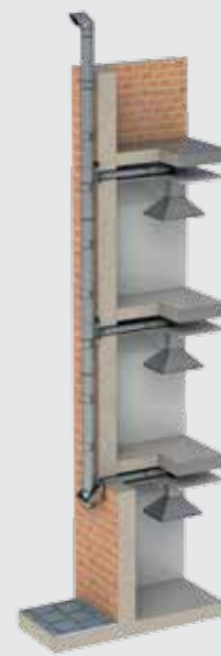
VENTILACIÓN CON CANALIZACIÓN INTERIOR
