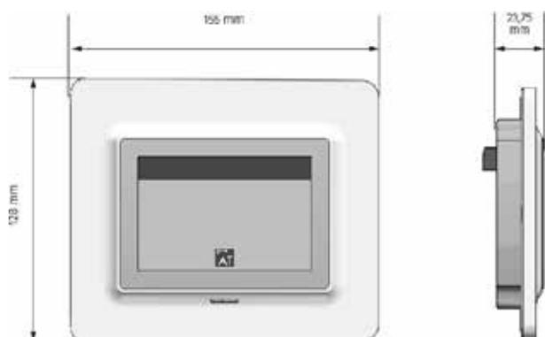
El Zonepad es un dispositivo táctil, retroiluminado, de pequeñas dimensiones y con termostato incorporado.
