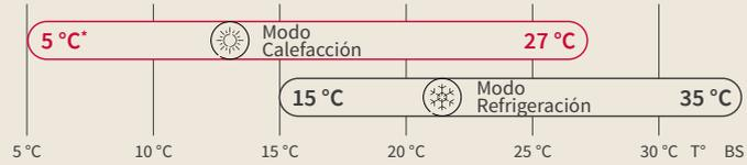
**T° de entrada del aire de la batería DX**
