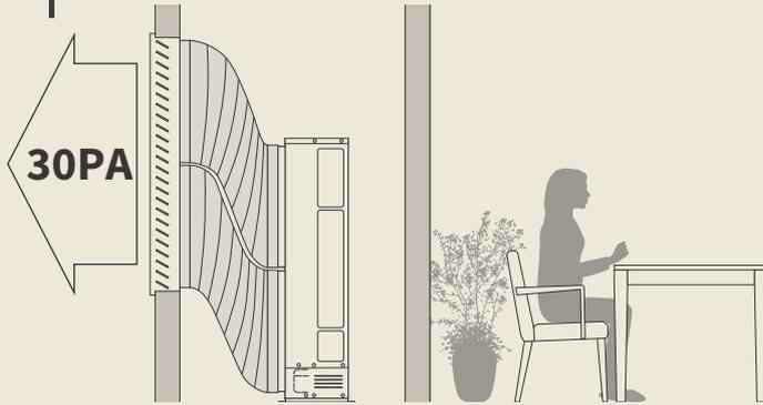
Con 30 Pa, la unidad exterior puede ocultarse. Esta solución permite canalizar la salida para forzar el paso del aire con velocidad a través de la rejilla y de este modo evitar el reciclaje.
