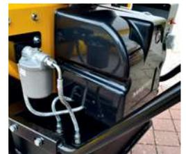
Cierre de depósito de combustible antifugas, con indicador de nivel
