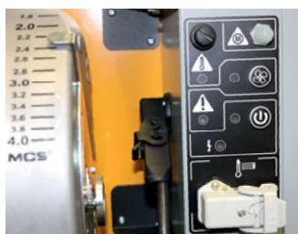
Panel de control y circuito eléctrico resistente al agua IP 67. Incluye botón on/off modo ventilador, botón reset, conector para termostato
