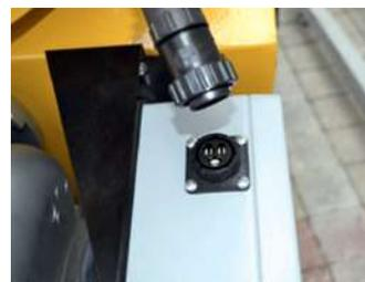
El motor está conectado al Panel de mandos con un conector de conexión rápida, para facilitar el mantenimiento.
