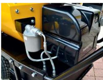
El filtro de combustible está en el exterior. La cabeza de combustión está dotada de pre-calentador de combustible.
