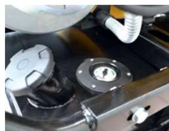
Cierre hermético y robusto del Depósito y cómodo indicador de nivel de combustible.
