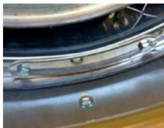
BV 500 tiene varios accesos con tapa al interior de la Cámara de Combustión, para su revisión, limpieza y lavado. La soldadura esta realizada por robots y posteriormente inspeccionada al 100%.
