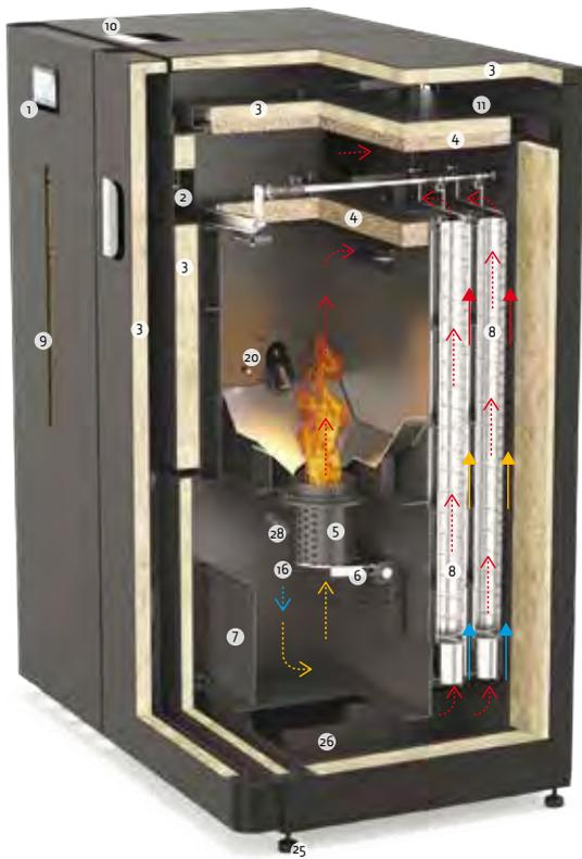
B. VISTA DE LA SECCIÓN POSTERIOR DE LA CALDERA AUTOMÁTICA Y PRINCIPALES COMPONENTES
