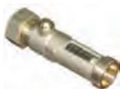
Caudalímetro de latón regulable de 20 a 70 litros/ minuto. Dn20. Pn10. Temperatura constante 120°C.
