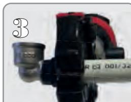
Colocar las cunas RF-Z, U o TH según el tipo de tubo (pex o multicapa) y presar comprobando que cierra correctamente.
