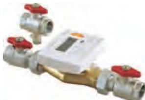
Kit contador de energía con válvulas de entrada y válvula adicional de 3 vías con portasonda. Pn10. Temperatura máxima 90°C.
