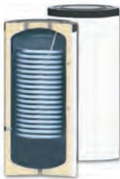
Depósito de inercia fabricado en acero negro especial para temperatura de refrigeración y calefacción, con serpentín primario en Inox de gran superficie (3 m<sup>2</sup>), para aerotermias de hasta 20Kw. El serpentín separa la aeroterma del circuito hidráulico de la instalación, garantizando el caudal correcto en la aeroterma, protegiéndola de suciedad e impurezas, y ahorrando en anticongelante en caso necesario. Garantía 5 años.
