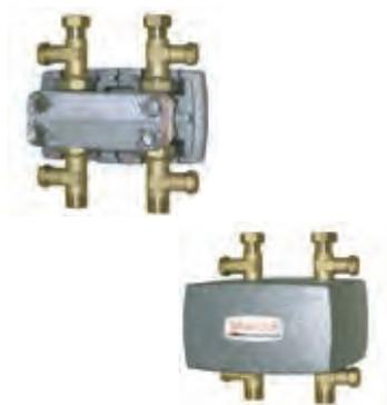
Módulo de placas soldadas de acero inoxidable AISI 316L para energía solar. Incluye aislamiento y salidas tipo T para conexión de válvulas. Pn10. Temperatura constante 120°C. Conexión 1". EPP 250x143x218
