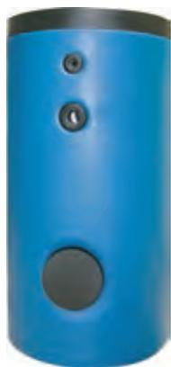
Depósito de 2 serpentines fabricado en acero al carbono de gran espesor. Modelo para ACS con tratamiento vitrificado o epoxi. Incluye ánodo de magnesio, garantía de 3 años. Con ánodo electrónico opcional 5 años.
