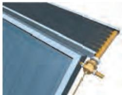
Sistema de disipación térmica por gravedad, sin necesidad de componentes eléctricos, compuesto de válvula termostática tarada a 90°C y batería para la disipación térmica según modelo.
