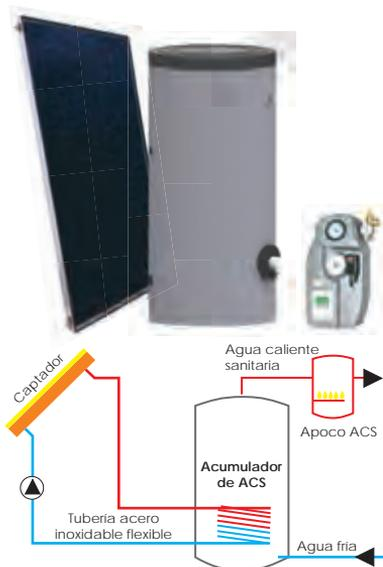
Equipo de circulación forzada presurizada para producción de ACS. Kits compuestos de captador con soporte, depósito interacumulador, grupo de bombeo, centralita, vaso de expansión, racorería y anticongelante. Soportes válidos para cubierta plana e inclinada.
