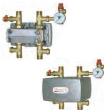
Módulo de placas soldadas de acero inoxidable AISI 316L para energía solar. Incluye aislamiento y salidas tipo T para conexión de válvulas, sondas y elementos de seguridad. Válvula de seguridad 50kW. Pn10. Temperatura constante 120°C. Conexión 1". EPP 250x143x218
