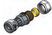
Racor macho con tuerca de compresión de bicono para unión de tubería de cobre de 15 mm a tubería plástica Pex o Multicapa.
