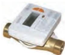
Contador de energía con una memoria de hasta 18 meses, con almacenamiento de consumo anual a partir de la fecha de referencia. Medición de flujo por medio de sistema de turbina volumétrica con control del número de vueltas de acuerdo con el principio de la conductancia eléctrica, sin el uso de imanes. Interfaz óptica específica para conectar un módulo de comunicación adicional: Radio comunicación, M-Bus o salida de impulsos.
