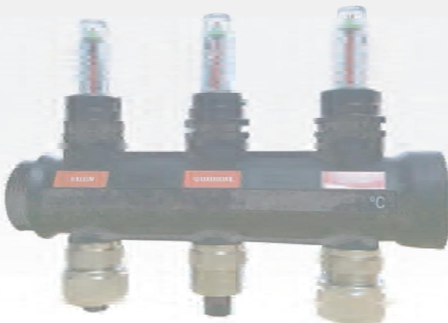
Colectores modulares de 2, 3 y 4 vías de 1" macho - hembra, montaje entre módulos con rosca sincronizada. Fabricado en PA66, reforzada con fibra de vidrio al 30% que permite obtener excelentes propiedades mecánicas, resistencia a la corrosión y sedimentos calcáreos.
