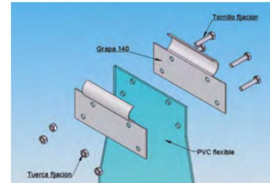
Esquema del sistema de ensamblaje de cortinas PVC
