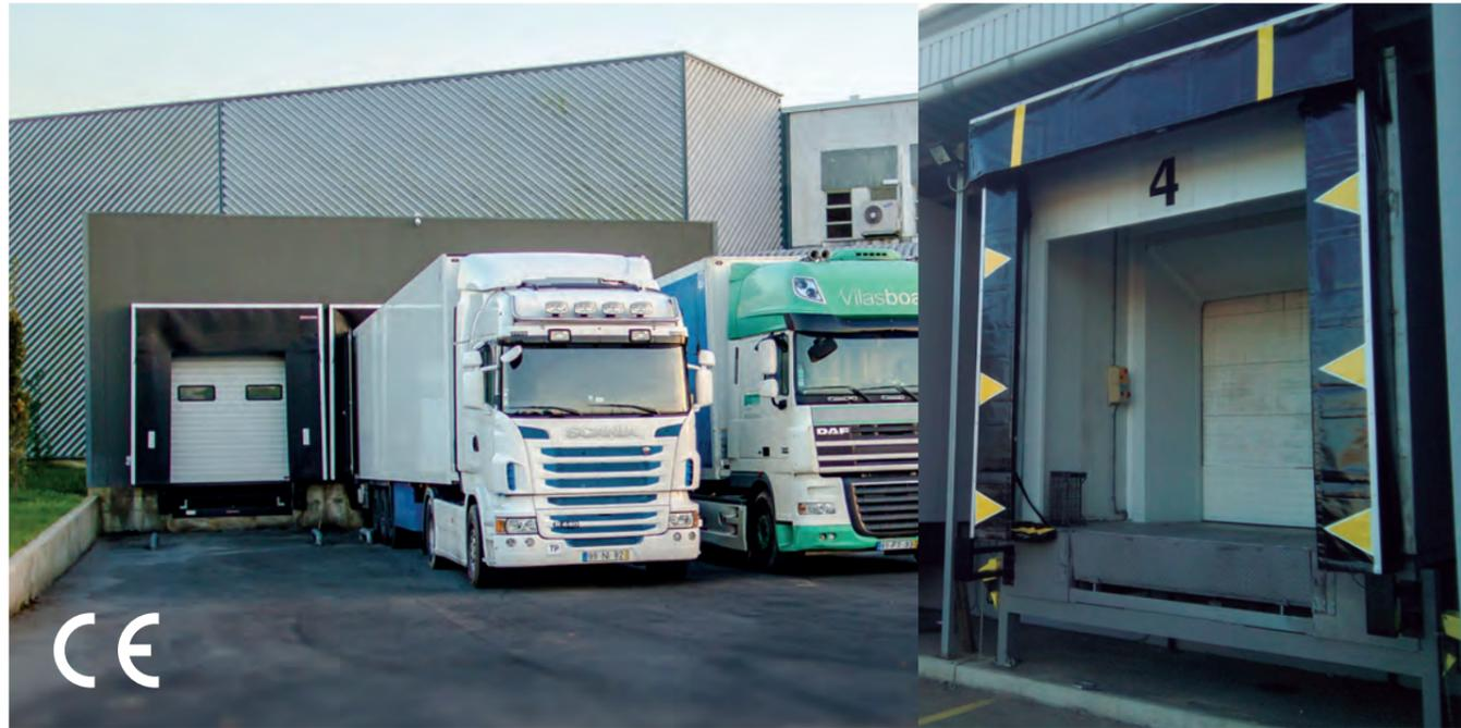
Los muelles de carga están diseñados para facilitar y optimizar las operaciones de carga y descarga de los camiones, principalmente en naves y almacenes que tienen un tráfico intenso de mercancías.
