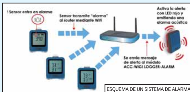
ESQUEMA DE UN SISTEMA DE ALARMA
