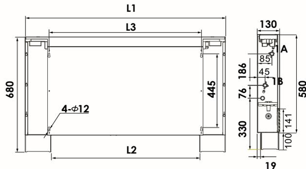
1. Conexiones hidráulicas en el lado izquierdo
