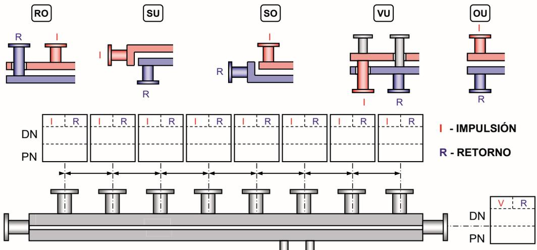
Colector General concéntrico de impulsión y retorno con aislamiento exterior y revestido con chapa galvanizada.
