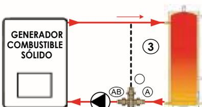
Cuando la temperatura del agua es superior a los 55°C, con un diferencial de +5°C la válvula de 3 vías anti-condensación cierra la entrada B y abre en su totalidad la entrada A, enviando por la salida AB una temperatura superior a 55°C.
