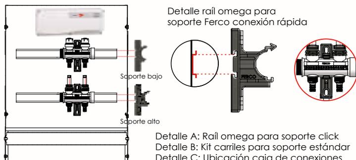
Detalle raíl omega para soporte Ferco conexión rápida
