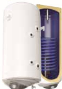
Depósito mural con 1 serpentín para producción de ACS, fabricado en acero al carbono con tratamiento vitrificado. Incluye ánodo de magnesio, válvula de seguridad (8bar), depósito con resistencia incluye termostato interno y selector ON/OFF. Con dos salidas de ½" para la conexión de vaina, sonda, etc. Garantía de 3 años.
