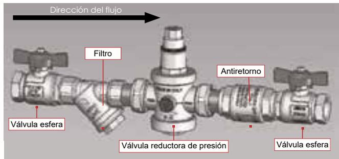
La instalación de las reductoras de presión se realiza normalmente en el suministro de agua fría. Se recomienda instalar en la entrada una válvula esfera y un filtro a la válvula reductora de presión, y a la salida una válvula de retención y una válvula esfera.
