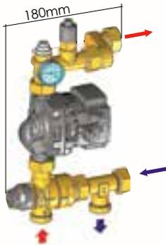
Grupo de bombeo con válvula mezcladora termostática de 3 vías, regulación manual de entre 35°C y 60°C. Grupo especial para instalación dentro de la caja de colector. Incluye bomba, válvula termostática, termómetro y purgador manual.
