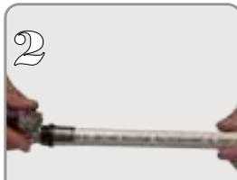
Introducir el extremo del tubo en el accesorio hasta hacer tope, visualizar su correcta colocación.
