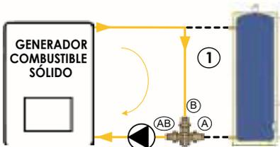
En su inicio la caldera impulsa el agua a una temperatura no superior a 55°C, para conseguir que la temperatura de caldera se eleve rápidamente la válvula mezcladora está recirculando entre la entrada B y salida AB hacia la caldera.
