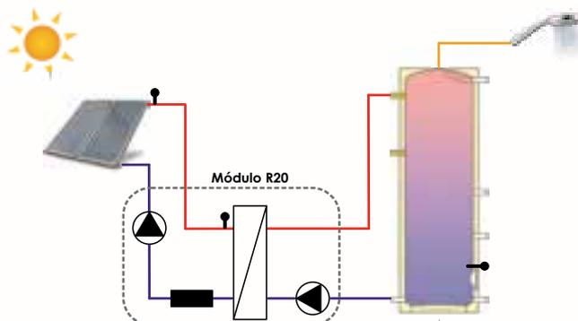
Módulo compacto completo para la gestión de acumulación de agua caliente para sistemas de energía solar térmica y control de válvula secundaria para calefacción u otras aplicaciones. Incluye bombas, intercambiador, racorería, elementos de seguridad y aislamiento EPP. No incluye válvulas.
