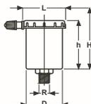
Purgador automático de boya con salida lateral, con válvula de purgado de alta calidad tipo obus.
