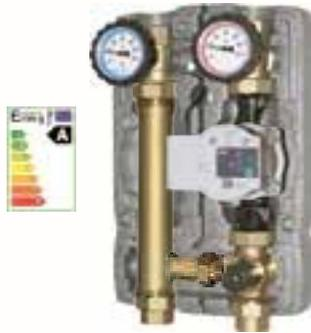
Grupo con válvula mezcladora de 3 vías. Pn10 bar. Temperatura máx. 110°C. Compuesto por vía de impulsión con válvula mezcladora, bomba circuladora y termómetro de impulsión, y en vía de retorno con tubo distanciador y termómetro de retorno. Incluye aislamiento EPP.
