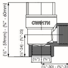
DIMENSIONES VÁLVULA SEGURIDAD H-H CALEFACCIÓN - ACS - SOLAR
