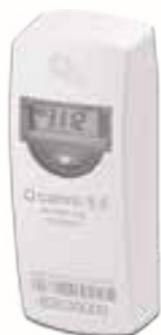
El repartidor de costes de calefacción Q calorific 5.5 permite una medición del consumo en cada radiador de la vivienda. La lectura remota de contadores puede efectuarse de forma tanto estacionaria como móvil (Modo S y C), ya que el repartidor de costes de calefacción Q calorific 5.5 emite telegramas AMR paralelamente con los telegramas walk-by.
