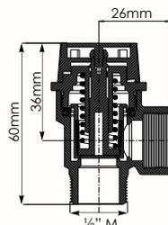
DIMENSIONES VÁLVULA SEGURIDAD M-H CALEFACCIÓN
