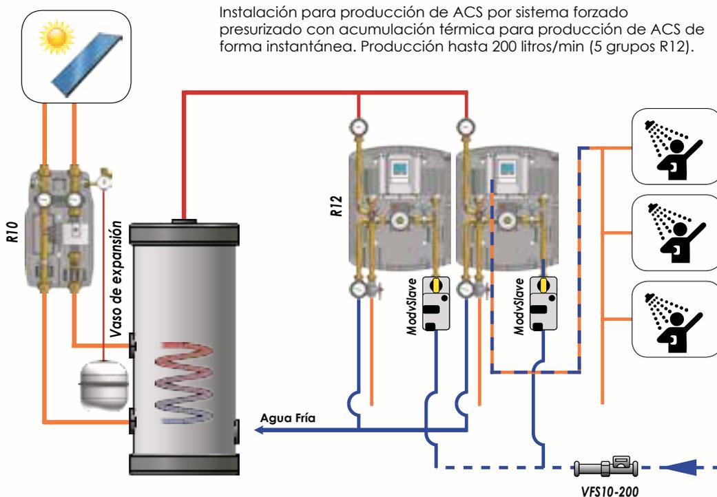
Grupo solar de 1 vía con y sin centralita. Pn10 bar. Temperatura máx. 120°C. Compuesto por vía de impulsión con válvula reguladora de caudal, válvulas de llenado, bomba, termómetro y equipo de seguridad compuesto por válvula de presión y manómetro, y salida para conexión de vaso de expansión. Incluye aislamiento EPP.
