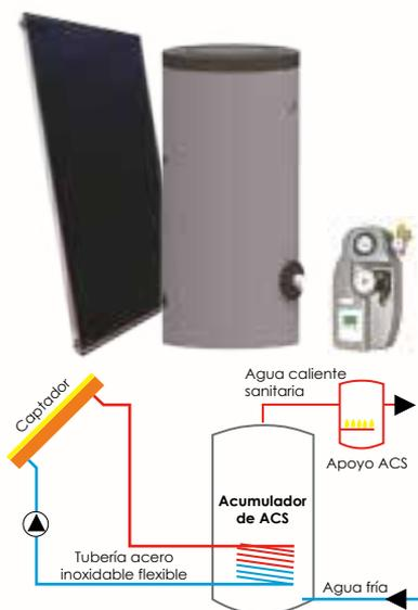
Equipo de circulación forzada presurizada para producción de ACS. Kits compuestos de captador con soporte, depósito interacumulador, grupo de bombeo, centralita, vaso de expansión y anticongelante. Soportes válidos para cubierta plana e inclinada.
