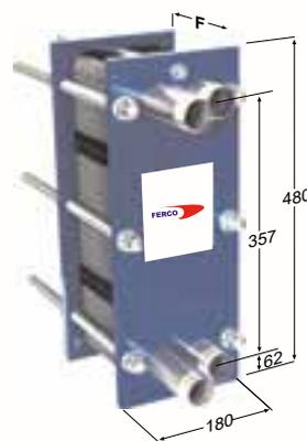
F= n°placas x 3mm + bastidor (16mm x 2)
