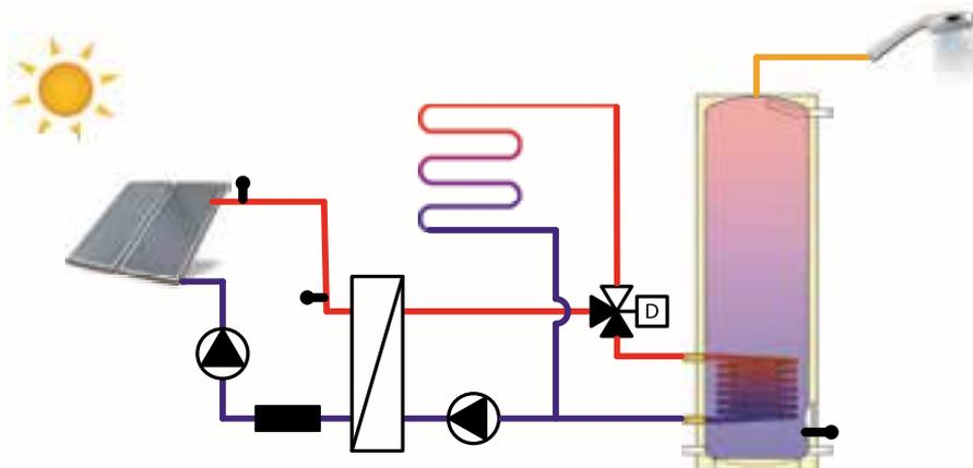
Grupo de mezcla para la producción de ACS instantánea. 3 variantes diferentes: con centralita y recirculación, con centralita sin recirculación, y con válvula termostática sin recirculación. Incluye aislamiento EPP.
