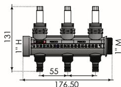
Juego de módulos de 1" M-H con rosca sincronizada de 3 vías fabricado en tecnopolímero PA + GF. Módulo con válvula termostatzable + Módulo con equilibrado regulable 0-5l/min.
