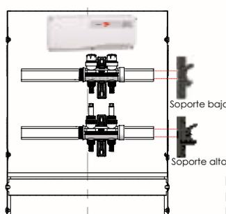
Detalle raíl omega para soporte Ferco conexión rápida
