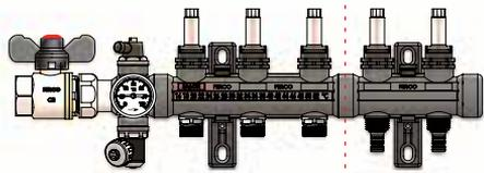
Colector de 1" retorno con válvula termostalizable, con termómetro bimetalico, purgador, válvula de llenado/vaciado y válvula de acometida de 1".
