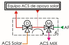
Funcionamiento con temperatura de acumulación solar inferior a 48°C
