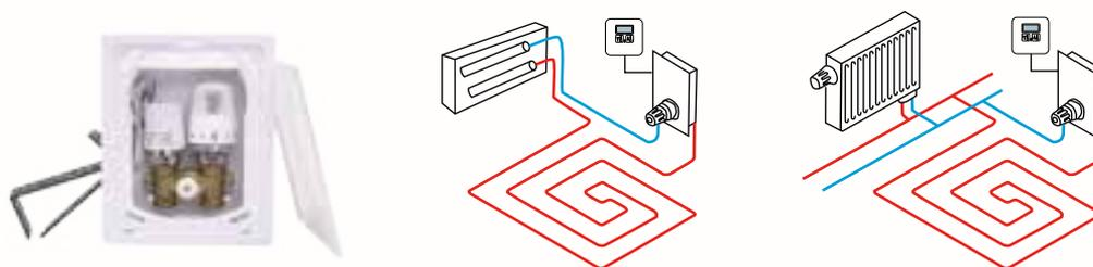
Caja colector individual de 1 o 2 circuitos con regulación hidráulica de 10°C a 50°C por actuador termostático bimetalítico y regulación de temperatura ambiente con actuador eléctrico controlado por termostato ambiente, no incluido. Termostato ambiente (Ver pag. 32/34).
