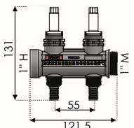
Juego de módulos de 1" M-H con rosca sincronizada de 2 vías fabricado en tecnopolímero PA + GF. Módulo con válvula termostatzable + Módulo con equilibrado regulable 0-5l/min.
