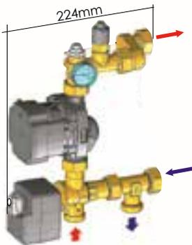
Grupo de bombeo con válvula mezcladora de sector de 3 vías con servomotor incluido. Grupo especial para instalación dentro de la caja de colector. Incluye bomba, válvula mezcladora con servomotor, termómetro y purgador manual.
