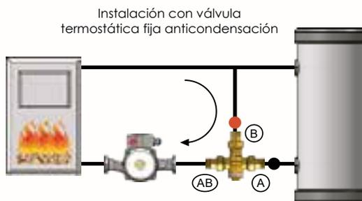
Válvula de 3 vías para control de temperatura de condensación. Garantiza el retorno a una temperatura fija al grupo térmico o caldera para evitar condensaciones en el hogar o en la chimenea. Posibilidad en diferentes temperaturas (45°C - 60°C - 70°C - 80°C). Bajo pedido
