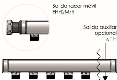
Con bocas superiores de 1/2" tapadas con tapón metálico más junta hasta fin de existencias.
