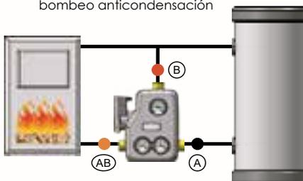
Instalación con válvula termostática fija anticondesación
