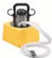
Bomba desincrustadora íntegramente en material plástico. Motor 230 Vac - 0,18 kW - Protección IP54. Caudal 2.200 L/h. Presión 1 bar. Peso 7 kg. Dimensiones 46x30Ø
