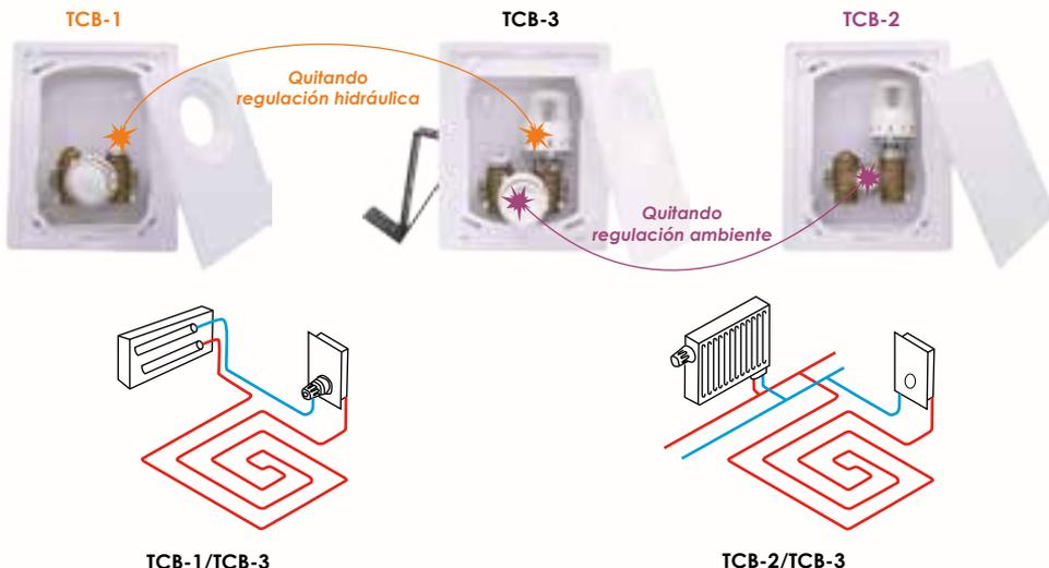
Caja colector individual de 1 o 2 circuitos con regulación hidráulica de 10°C a 50°C por actuador termostático bimetalítico y regulación de temperatura ambiente por actuador termostático bimetalítico de 6 a 28°C. Posibilidad de realizar 3 funciones:
