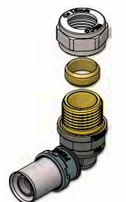
Codo macho con tuerca de compresión de bicono para unión de tubería de cobre de 15 mm a tubería plástica Pex o Multicapa. Válido solo para modelos de nueva generación, consultar disponibilidad.
