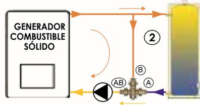
Cuando el agua va subiendo de temperatura y alcanza los 55°C, la válvula de 3 vías anti-condensación abre proporcionalmente la entrada A. Garantizando la recirculación por la entrada B hacia la caldera a una temperatura no inferior a 55°C, evitando así la condensación.
