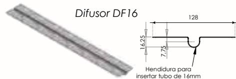
Sistema radiante seco, sin necesidad de mortero. Con posibilidad de realizar instalación de forma estándar, realizando circuitos en espiral, obteniendo una emisión térmica homogénea.
