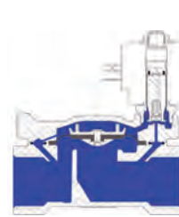
Bobina energizada / Coil energized Electroválvula abierta / Solenoid valve open
