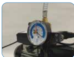
Conexión con bomba de vacío
