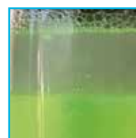
Refrigerante y aditivo con contaminación de agua
